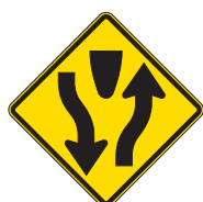
Comienzo división autopista
