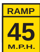
Velocidad recomendada en la rampa
